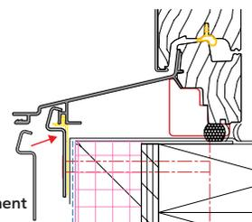
**AVIS** Vérifiez que les ailettes d'étanchéité et les couvre-aillettes ne sont pas endommagés. Ajoutez du ruban d'étanchéité au besoin pour réparer les ailettes ou coins d'aillettes endommagés.
