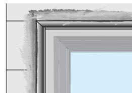
C. **Apposez le ruban d'étanchéité des côtés droits.** Coupez deux morceaux de ruban d'étanchéité 10,16 cm plus longs que les côtés droits. Apposez le ruban sur l'ailette et la membrane plane autoadhésive. Étendez le ruban 5,08 cm au-dessus et en dessous des côtés droits.
