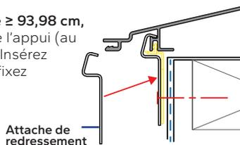
**AVIS** Vérifiez que les ailettes d'étanchéité et les couvre-aillettes ne sont pas endommagés. Ajoutez du ruban d'étanchéité au besoin pour réparer les ailettes ou coins d'aillettes endommagés.
