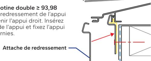
**AVIS** Vérifiez que les ailettes d'étanchéité et les couvre-ailettes ne sont pas endommagés. Ajoutez du ruban d'étanchéité au besoin pour réparer les ailettes ou coins d'ailettes endommagés.
