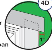
E. **Appliquez une deuxième couche de ruban d'étanchéité pour joints du fabricant de revêtement.** Coupez un morceau de manière à ce qu'il dépasse de 2,54 cm la première couche de ruban d'étanchéité de chaque côté. Superposez la première couche de ruban d'étanchéité de 2,54 cm pour créer un effet de drainage.
