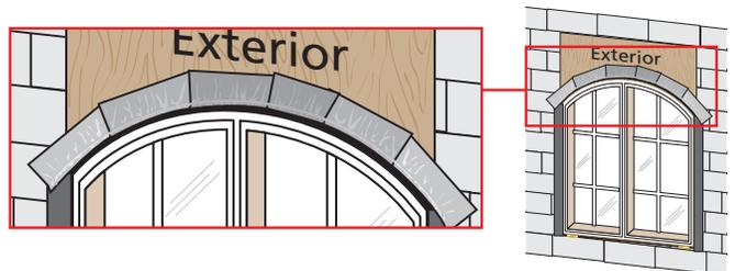
**NOTA:** inserte calzas debajo de la aleta del alféizar para asegurarse de que la aleta de sujeción no se selle al tapajuntas aplicado en forma líquida.
