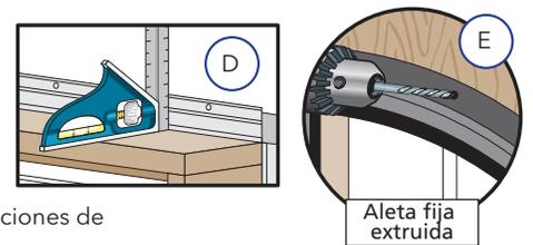
**Unidades curvas con aletas flexibles:** Instale sujetadores o pretaladre orificios para los tornillos del marco Unidades curvas con aletas rígidas: Pretaladre orificios a través de la aleta.
