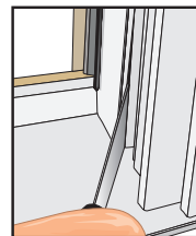
Sujetador de soporte de forro de jamba para abertura Monumental
